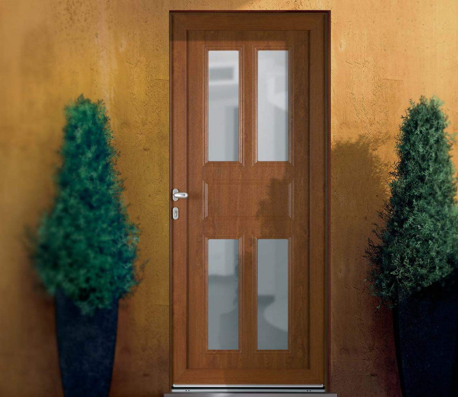
**ENTRY CLIMATEK.** Sistema costruito con profili **VEKA in classe "A"**, estrusi con mescole **in classe "S"**, struttura da 82 mm., 6 camere e **tripla guarnizione di battuta** in TPE/EPDM.
